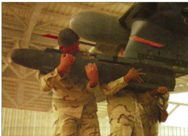
Подвеска УР АГМ-114 «Хеллфайр» класса «воздух – земля» на штурмовик АС-208В
