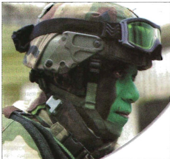
Многофункциональный шлем со съемной оптоэлектронной системой и аудиогарнитурой (остеомикрофон ОН-295, справа)
